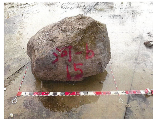
調査箇所で確認された岩塊 (約1300mm × 1000mm × 800mm、約2500kg)
