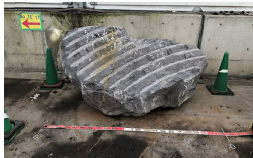
岩塊群を構成していた岩塊 (長辺2m程度、表面の傷はシールドマシンの刃の痕跡)
