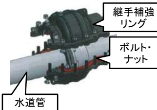
対応策イメージ(水道管継手補強)
