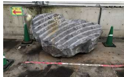
岩塊群を構成していた岩塊 (長辺2m程度、表面の傷はシールドマシンの刃の痕跡)
